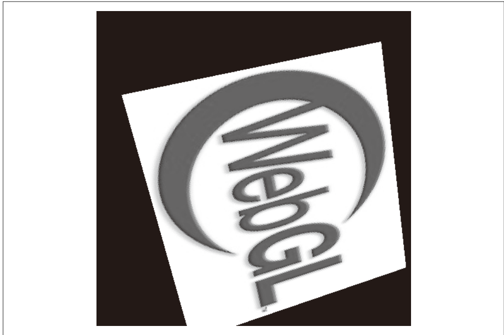
图 2-4: gl.NEAREST 过滤——近处物体上的纹理变得像素化
